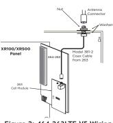
Figure 2: 464-263LTE-V5 Wiring
